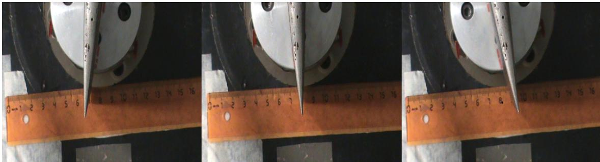
Figura 2.18: Visualización del fin del ala sobre regla calibrada.
