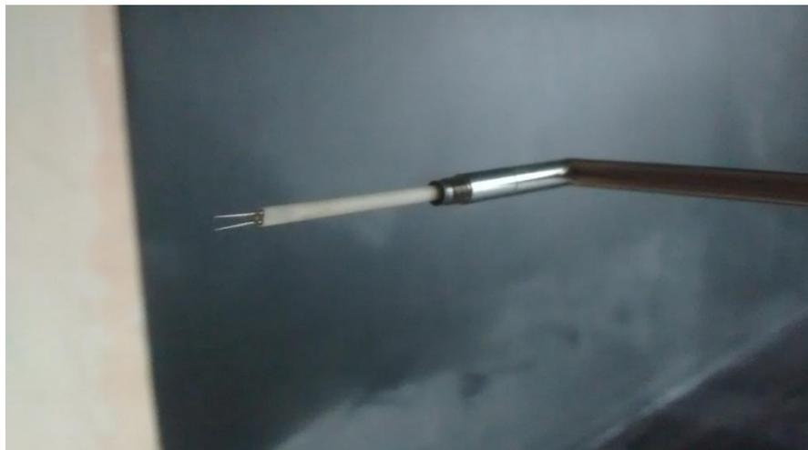
**Figura 29: Fotografía de la sonda perpendicular instalada para las mediciones en el Túnel de Viento**
