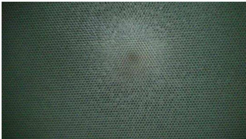
**Figura 5: Fotografía del panel de abeja interior de la cámara de acondicionamiento de flujo presente en el Túnel de Viento.**
