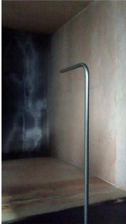
Figura 20: Fotografía del Tubo de Pitot instalado en el Túnel de Viento.
