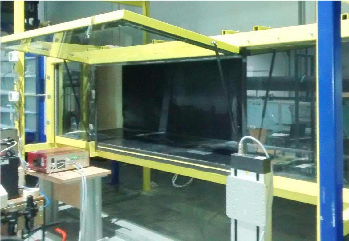
Figura 7: Fotografía de la cámara de ensayo presente en el Túnel de Viento
