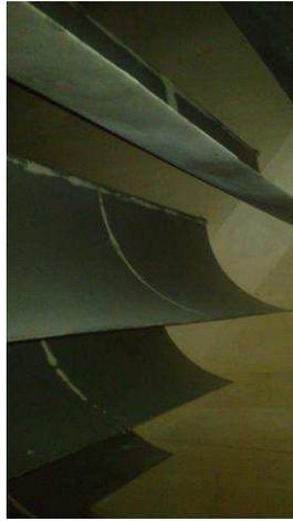
**Figura 4: Fotografía de los deflectores presentes en los codos del Túnel de Viento**
