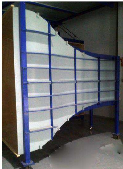
**Figura 6: Fotografía de la contracción presente en el Túnel de Viento**
