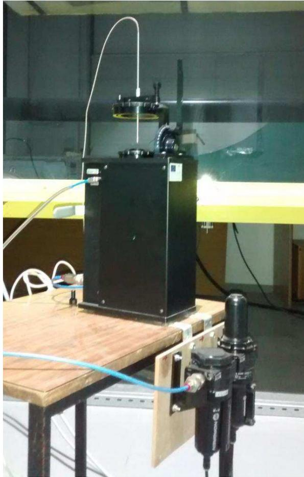
**Figura 18: Fotografía del Calibrador de Hilo Caliente 54H10 de DANTEC°**
